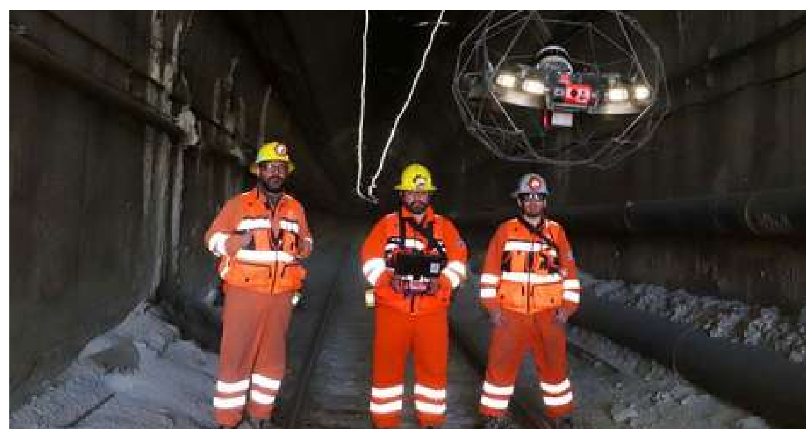
Flyability - Modelamiento 3D de túneles con dron en el Teniente, Chile
