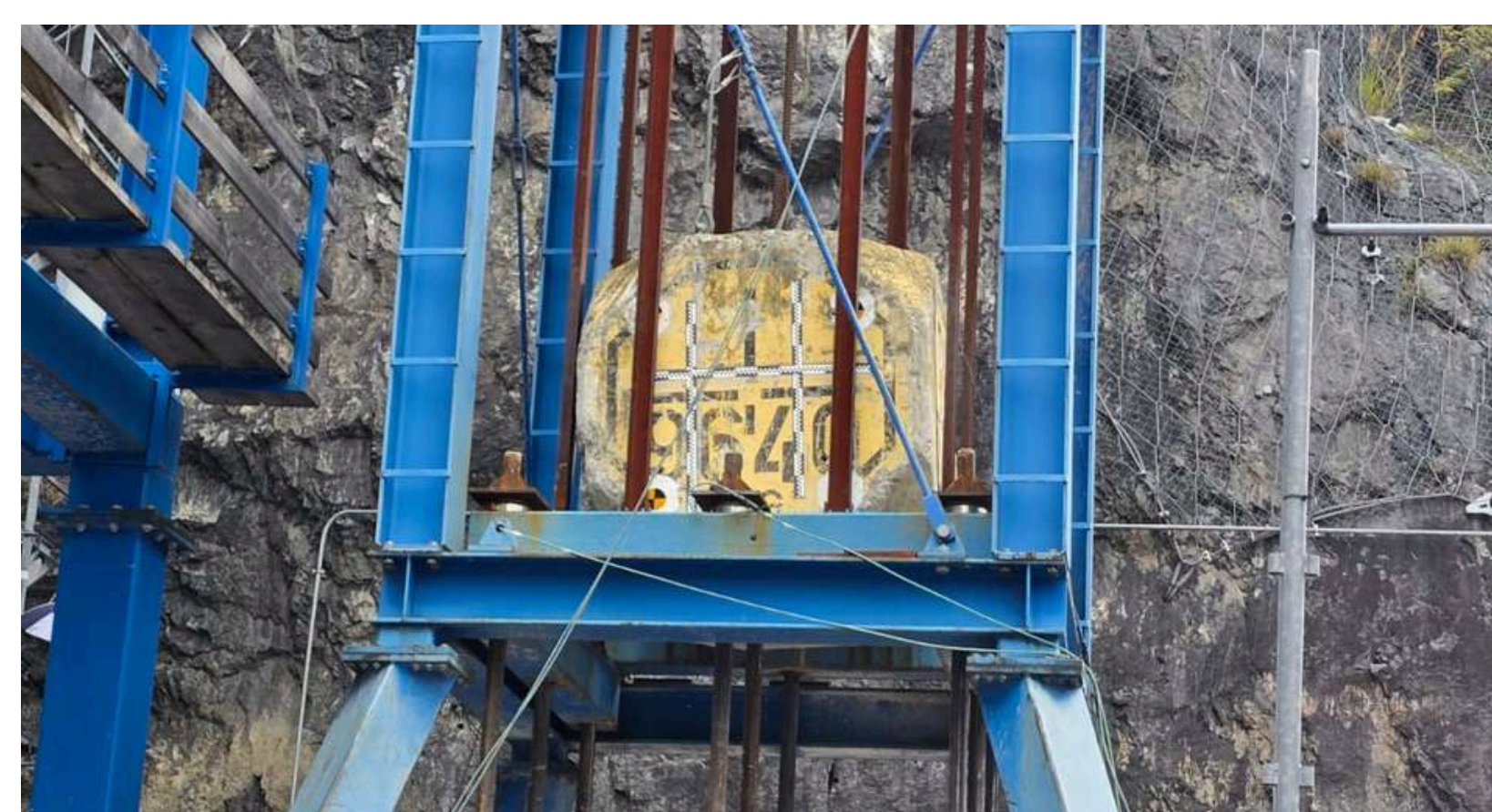
Geobrugg - Ensayo dinámico de soporte de túneles en el centro de pruebas de Walenstadt
