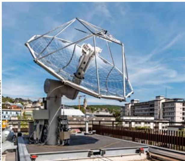
Los investigadores de la Escuela Politécnica Federal de Zürich (ETH) han desarrollado una tecnología capaz de producir combustibles líquidos a partir de luz solar y aire.
